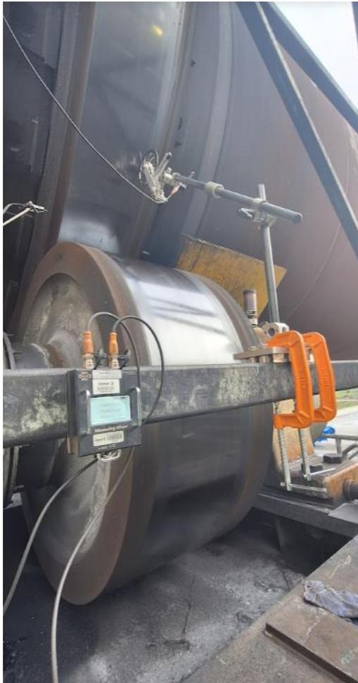
O dispositivo mede o perímetro com base na leitura de um **encoder**, onde É possível obter o diâmetro dos rolos de apoio e alianças durante a operação;
