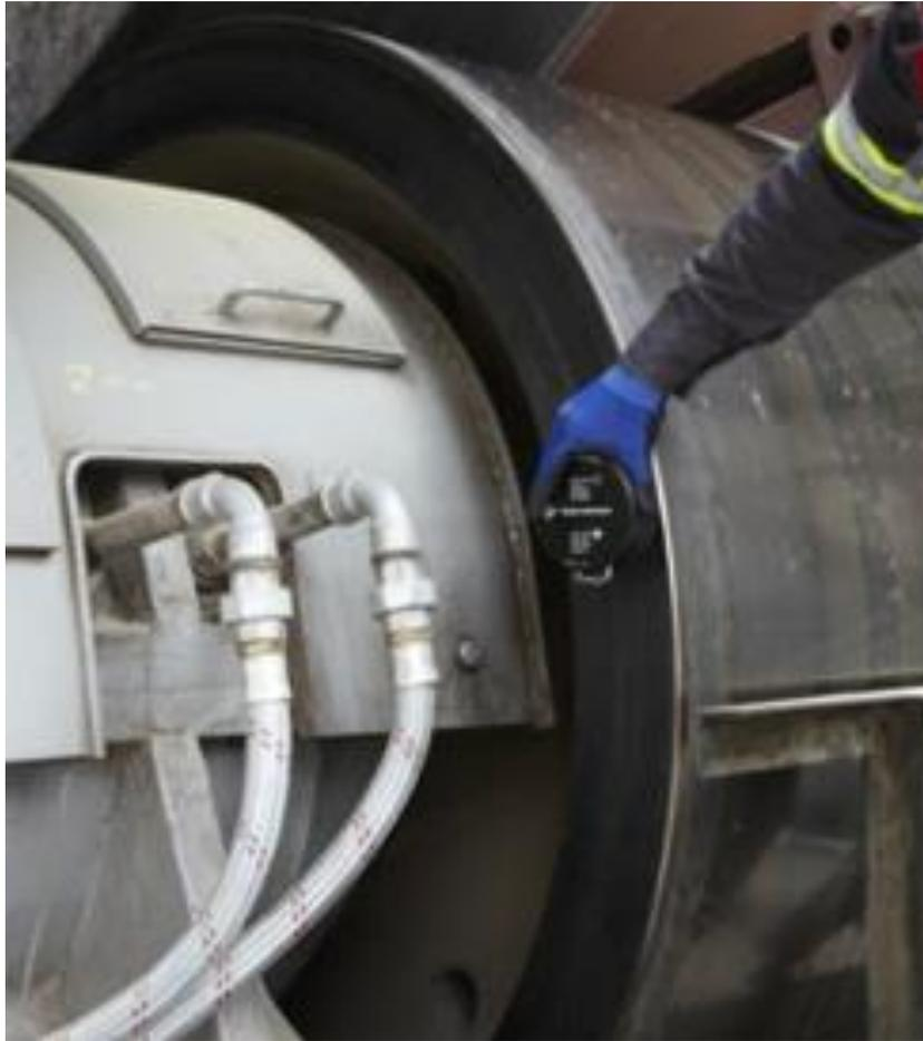
O Inclinômetro rotativo é uma ferramenta de medição, que indica as inclinações do eixo das peças rotativas durante a operação.
