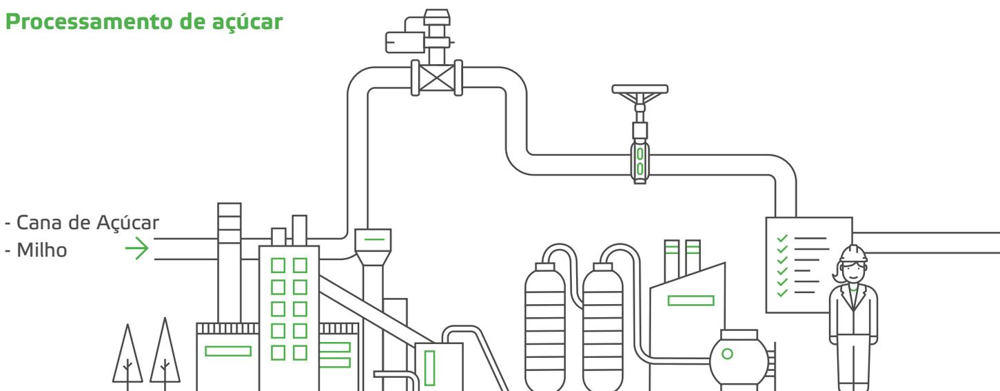
O processo de produção de açúcar de cana e milho envolvem altas temperaturas, produtos químicos corrosivos e altas velocidades de fluxo. A Valmet oferece válvulas de alto desempenho para cada estágio do processo, da moagem e extração para filtração e tratamento químico, para refinação.
